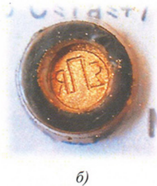
Рисунок 2 – Геометричні параметри (а) та загальний вигляд (б) відбитку тавра виробника, що застосовується для пломбування гвинта, встановленого в корпусі лічильника
